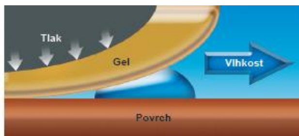
Hydrofóbné vlastnosti hmoty PowerGel.
