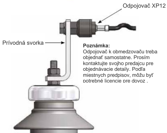
L5 Prívodná svorka (obvykle používaná s odpojovačom XP12)
